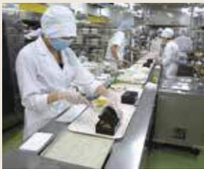
配膳専用のベルトコンベアで配膳
